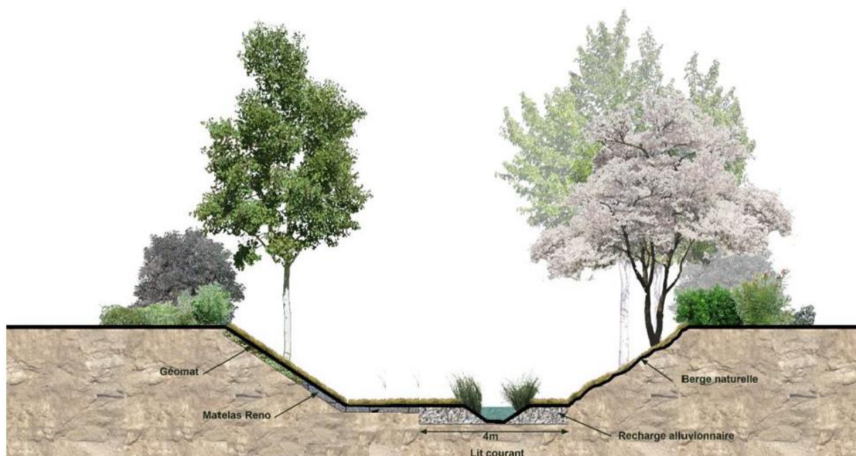
Coupe type du lit du Rieumassel après réalisation du projet – Source : AVP
